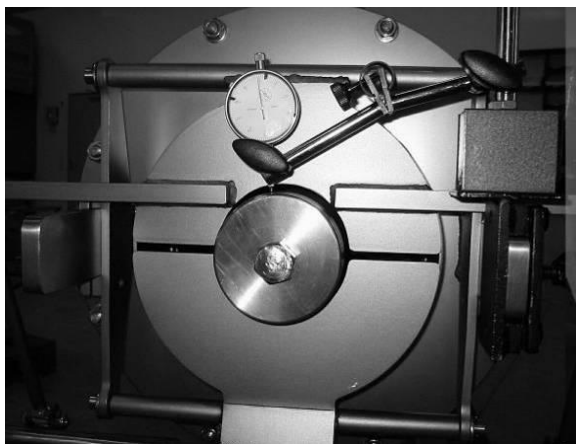
Abb. 13-13: Kontrolle des Taumelschlages der Schnecke
