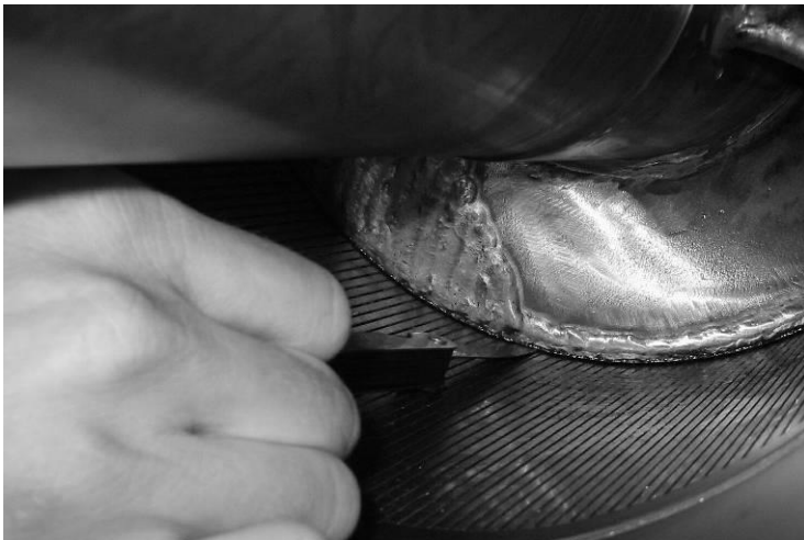
Abb. 13-15: Messung des Arbeitsspalt zwischen Sieb und Schnecke, gemessen wird an der Unterseite des Siebes bei Stillstand der Maschine, die Messung ergibt den 2-fachen Arbeitsspalt, da im ruhenden Zustand das Sieb oben auf der Schnecke aufliegt.
