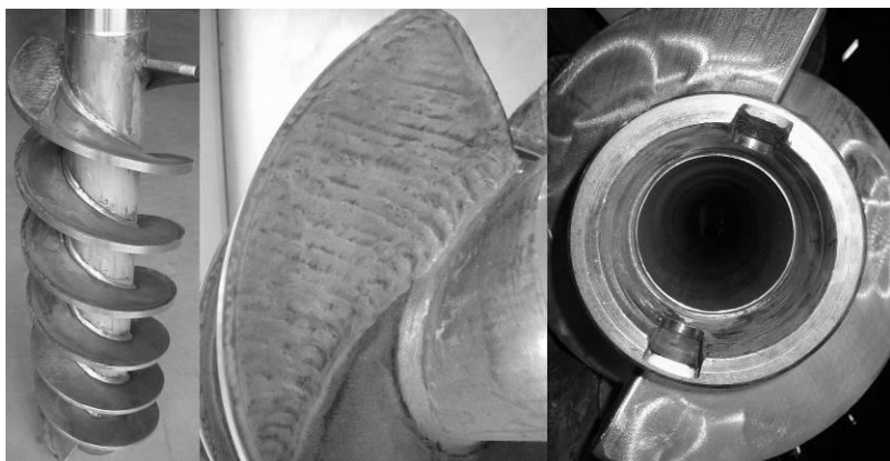
Abb.13-12: Schnecke mit gepanzertem Spezialwerkstoff und Nabenaufnahme, Neuzustand
